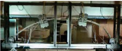
図4: 3D震動台によるRCアーチの破壊実験
