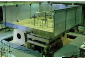
図5: 3D震動台の応用 (家具の挙動の実証)
