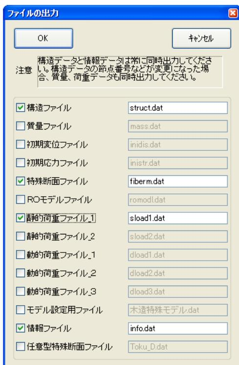
9. データ入力情報を SPACE の仕様に合わせて、ファイル出力する。ファイル出力メニューから、左図のダイアログを表示させ、出力させるファイルを選択する。
