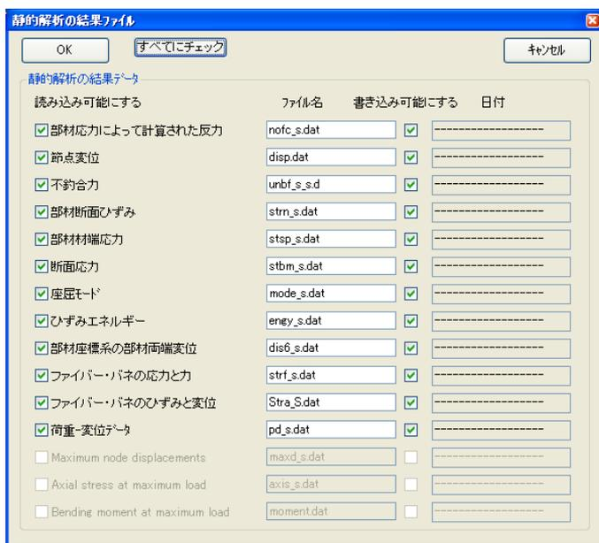
図 4-16 静的解析の結果ファイルダイアログ
