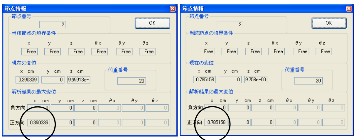
図 6-17 骨組柱頭の水平方向変位
