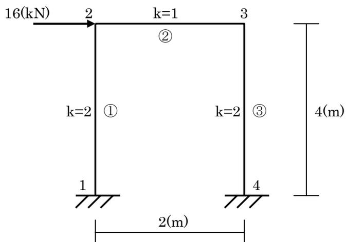
問2 次を示す構造物をたわみ角法で解き、モーメント(M)図、せん断力(Q)図を求めなさい。
