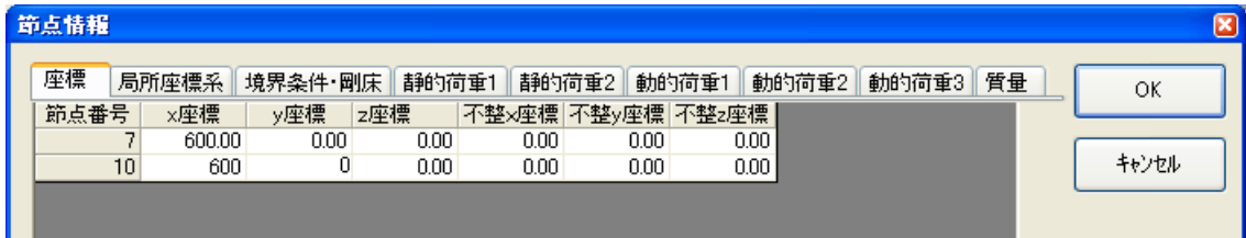
図 10-31 節点 10 の座標を節点 7 の座標と同じとなるように設定
