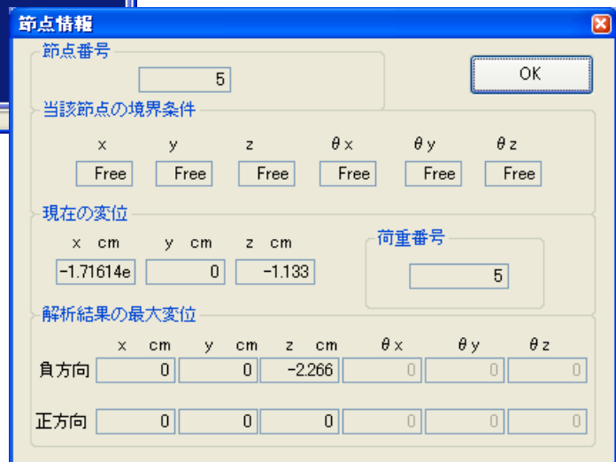
図 10-24 片持ち梁先端の変位
