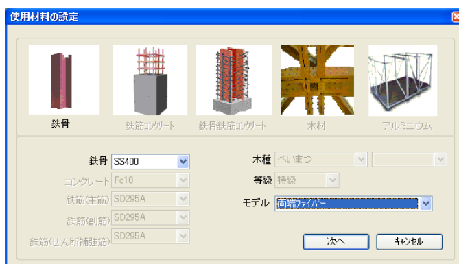
図 9-12 使用材料の設定ダイアログで、鉄骨と両端ファイバーモデルを選択
