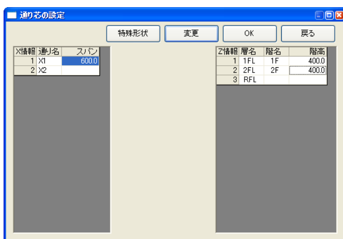
図 2-18 スパンと階高さの設定
