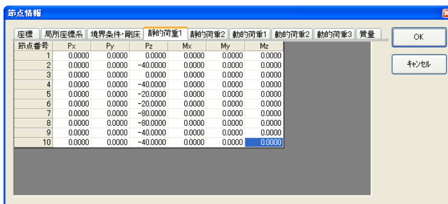
図 6-22 (b) 節点情報を表示させ、荷重を確認する
