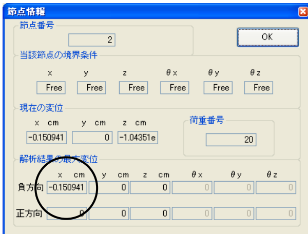
図 3-39 骨組柱頭の水平方向変位
