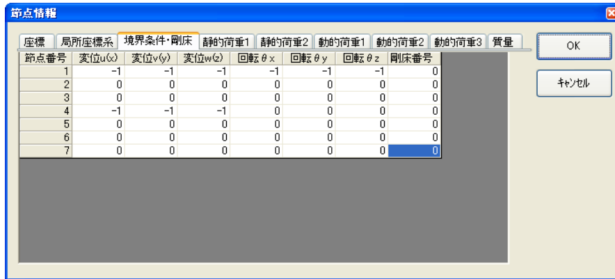
図 2-31 (a) 節点情報を表示させ、境界条件を確認する
