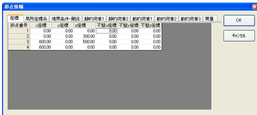
図5-25 節点情報を表示させ、座標を変更し、片流れ屋根の形状にする
