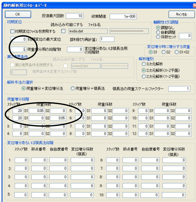
図 7-19 静的解析解析用コントロールデータ
