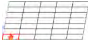
図 3 火災時の全体崩壊した構造物
