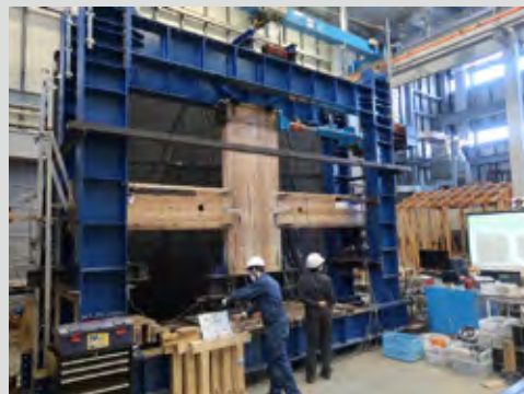
中高層木造建物の開発実験の様子
