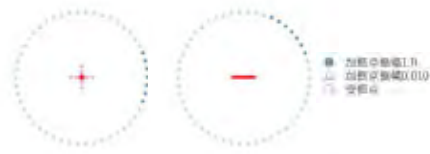
空間自己相関法（東） 地震波干渉法（北東） 図1 到来方向を限定した仮想振源と受振点の配置 （加振点半径 600m の例）
