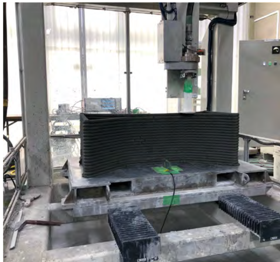
3D プリンティング技術の実験風景。即座に固まる素材を追求する。
