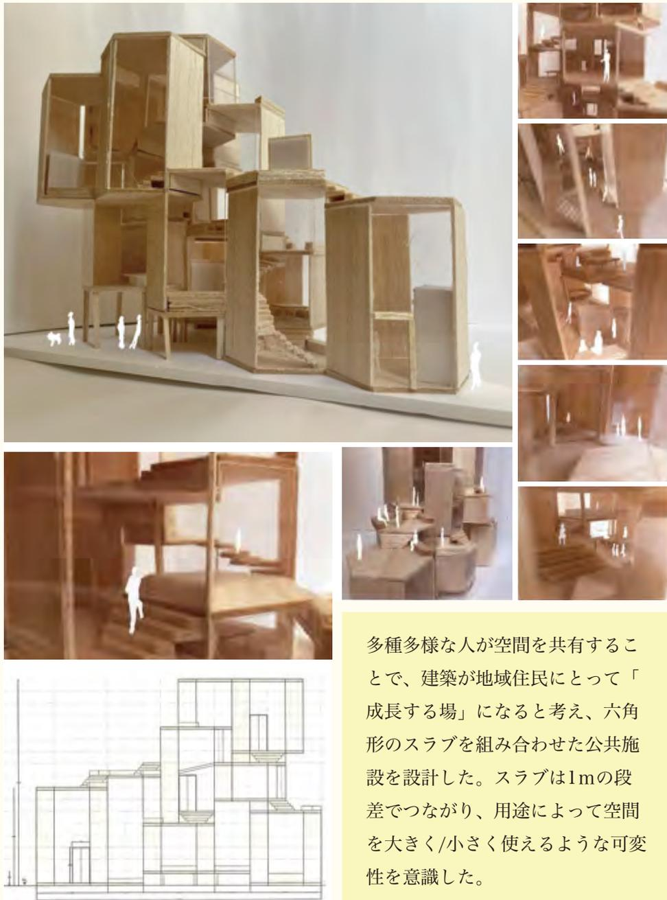
多種多様な人が空間を共有することで、建築が地域住民にとって「成長する場」になると考え、六角形のスラブを組み合わせた公共施設を設計した。スラブは1mの段差でつながり、用途によって空間を大きく/小さく使えるような可変性を意識した。
